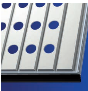
■ Variante SBL Torflügel aus Aluminiumprofilen, Abb. E6 / EV1 eloxiert, Torbelag Auflage Sickenlochblech SBL, Abb. Belag ähnlich RAL 9016 verkehrsweiß, Lüftungsquerschnitt der Füllung ca. 7%.
